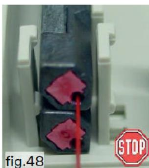
fig.48 Epissures MAL positionnées.
